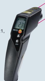
Termometro a infrarossi rapido e universale con puntatore a 1 raggio laser e ottica di misura 10:1, in esecuzione ergonomia "a pistola".
