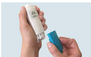
Semplice sostituzione delle sonde con testo 206-pH1/-pH2/-pH3
